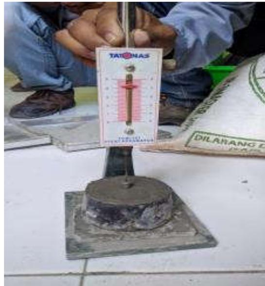
GAMBAR 1.1 Pengujian Konsistensi Semen Portland
